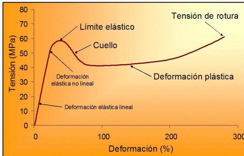
Figura 12. Comportamiento tensión vs. Deformación de un polímero termoplástico.
