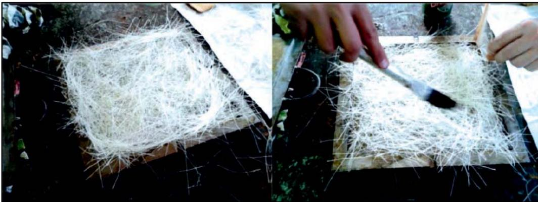
Figura 15. Colocación e impregnación de las fibras con la resina en el molde.
