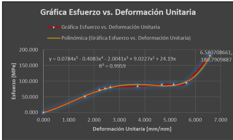
Figura 13. Ajuste de la curva para determinar la función polinómica.
