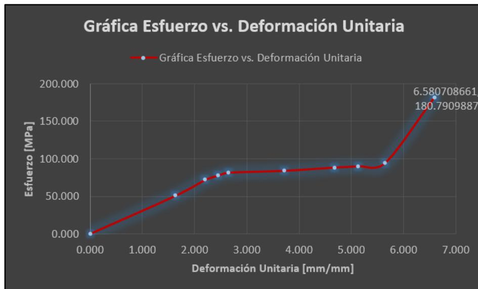
Figura 8. Gráfica Esfuerzo vs. Deformación Unitaria.
