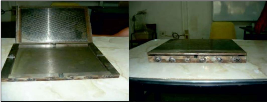
Figura 14. Molde empleado para la fabricación del material compuesto.
